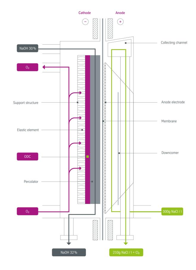
2 NaCl H<sub>2</sub>O 1/2 O<sub>2</sub> Cl<sub>2</sub> 2 NaOH
